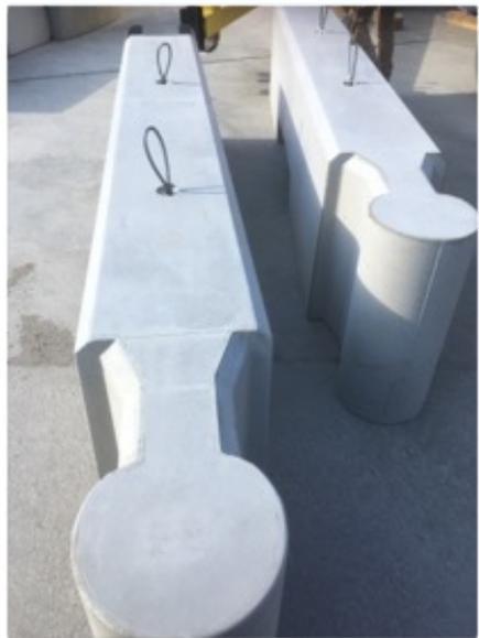
Le Wibloc large utilise le même système de couplage et est donc compatible avec le Wibloc ordinaire. De plus, le Wibloc large n'a pas besoin d'être placé sur une ligne droite et peut également varier en hauteur entre la chaussée et le trottoir. Le Wibloc large pèse 2 tonnes et peut être placé à l'aide d'un chariot élévateur ou avec une grue.
